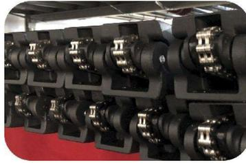
Transmission par chaîne en acier inoxydable super épaisse
